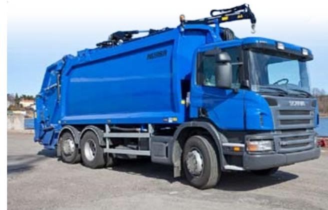
складывающейся стрелой между кузовом и кабиной. КМУ в обоих случаях управляется с помощью дистанционного пульта, благодаря чему водитель мусоровоза свободно перемещается по площадке и полностью контролирует процесс опустошения «чулка» в компактор. Поскольку краны работают легко и бесшумно, вывоз ТБО эти мусоровозы могут производить в любое время суток.
