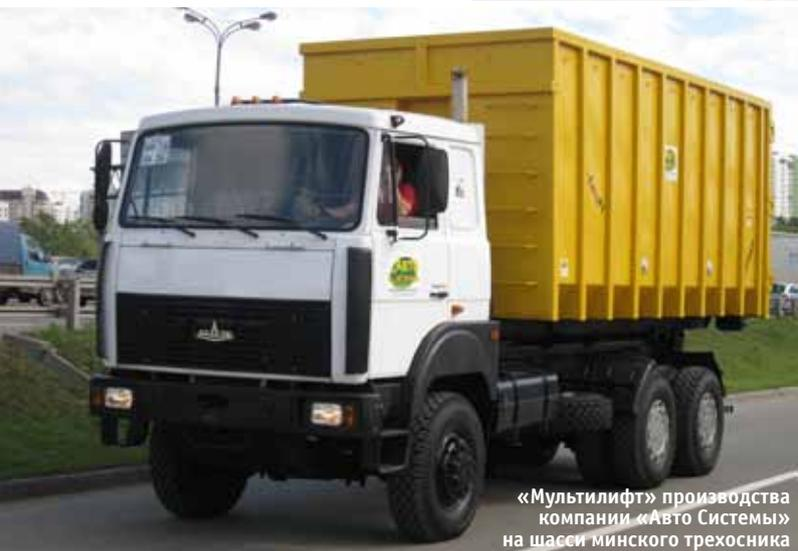
«Мультилифт» производства компании «Авто Системы» на шасси Минского трехосника
