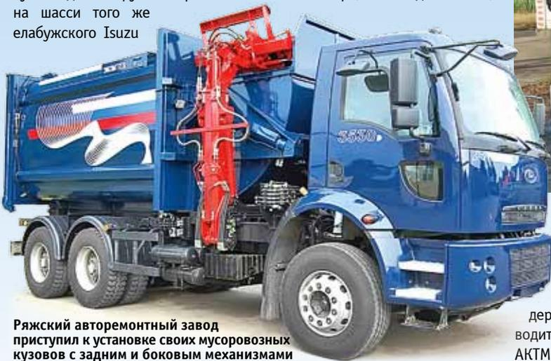
Рязский авторемонтный завод приступил к установке своих мусоровозных кузовов с задним и боковым механизмами погрузки на шасси автомобилей Ford
