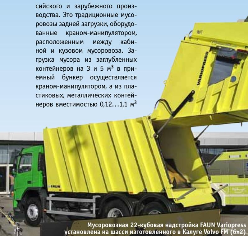
Мусоровозная 22-кубовая надстройка FAUN Variopress установлена на шасси изготовленного в Калуге Volvo FM (6x2)
