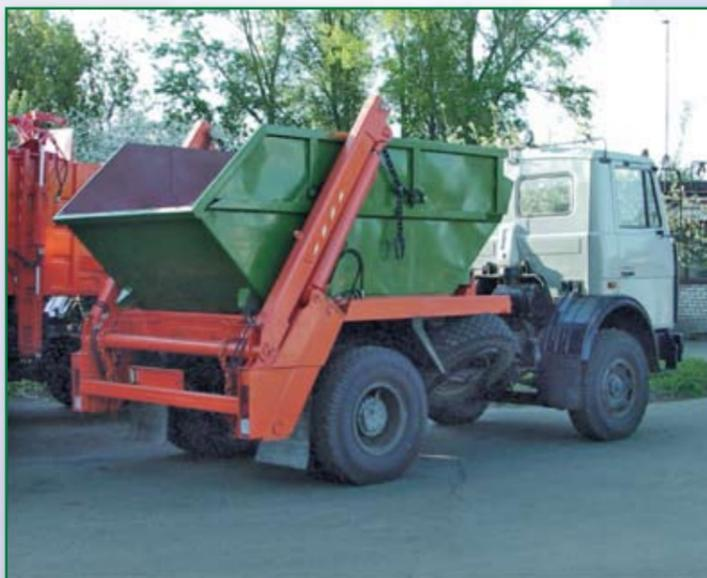
Мусоровозы МКС-1 и МКС-3501 являются универсальными контейнерными мусоровозами, позволяющими выполнять комплекс работ по сбору и вывозу крупногабаритных отходов, строительных и промышленных отходов, накапливаемых в сменных контейнерах вместимостью 8-10м<sup>3</sup>.
