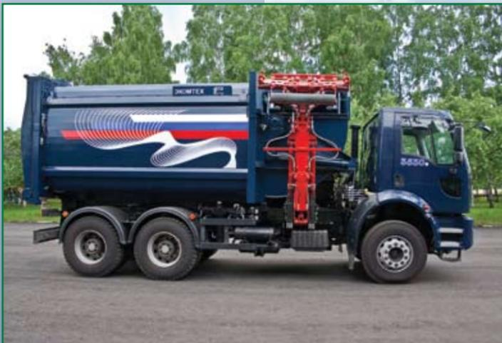
**Мусоровозы с маятниковой уплотняющей плитой – это мусоровозы МКМ-44108, МКМ-7007 с боковой загрузкой, в которых реализованы новые технические решения, позволившие резко повысить производительность загрузки кузова, втрое увеличить коэффициент уплотнения мусора (до 6-ти) и максимально использовать полезную грузоподъемность базового автомобиля КАМАЗ, МАЗ, FORD.**
