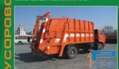
ТРАДИЦИОННЫЙ МУСОРОВОЗ С ЗАДНЕЙ ЗАГРУЗКОЙ • ДЛЯ ПЛАСТИКОВЫХ КОНТЕЙНЕРОВ 0,12 – 1,1 М3, СТАНДАРТНЫХ 9,0 М3, ОЦИНКОВАННЫХ 0,77 – 1,1 М3 И БУНКЕРОВ 7,3 М3
