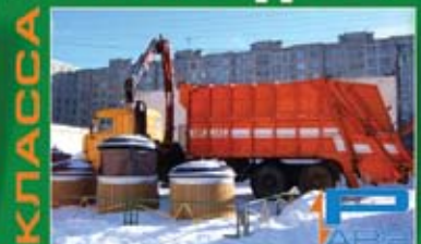
ТРАДИЦИОННЫЕ МУСОРОВОЗЫ С КРАНОМ МАНИПУЛЯТОРОМ • ДЛЯ КОНТЕЙНЕРОВ ЗАПУЛНЕННЫХ И ПОДВЫННЫХ 3 М3 И 5 М3, ПЛАСТИКОВЫХ И ОЦИНКОВАННЫХ 0,77 – 1,1 М3 И БУНКЕРОВ 7,3 М3
